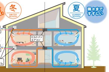
高性能熱交換器ユニットで、家全体を給排気。湿気の侵入や過乾も緩和します。24時間常時換気。熱交換機能により、熱ロスが少なく、省エネ性に優れています。
