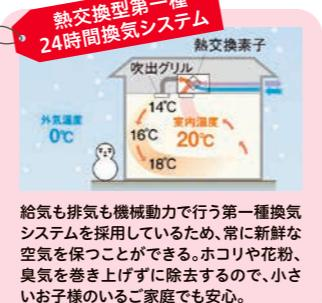
給気も排気も機械動力で行う第一種換気システムを採用しているため、常に新鮮な空気を保つことができる。ホコリや花粉、臭気を巻き上げずに除去するので、小さいお子様のいるご家庭でも安心。
